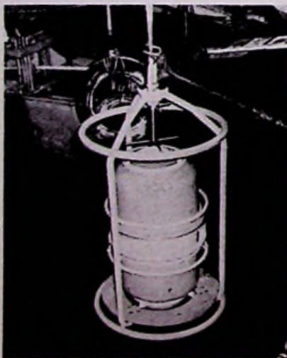
Onderwatertrommel van de L55/NIMBUS 6 boei die gevuld is met allerhande elektronische apparatuur.
